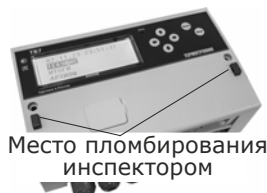
Рис. 1.2– Места пломбирования вычислителя
