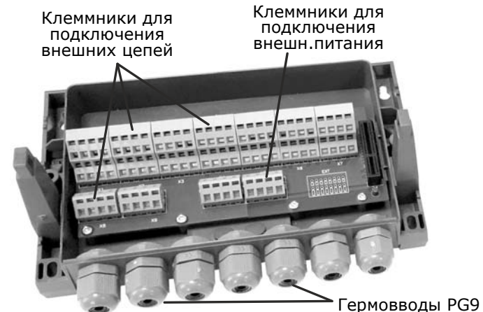
Рис. 2.4 – Вид на монтажный отсек при снятой крышке
