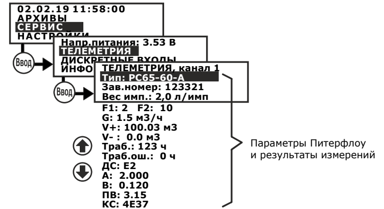
Рис. 3.11 – Порядок просмотра состояния расходомера Диагностические сообщения от расходомера передаются в системе кодировки NAMUR. Перечень диагностических сообщений приведен в таблице 11.
