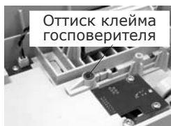
Рис. 1.2– Места пломбирования вычислителя
