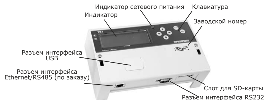
Рис. 2.1 – Внешний вид приборного отсека ТВ7 (вид сверху)
