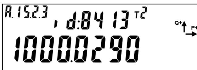
Рисунок 25 – Информация модуля связи, подключенного к COM (N)
