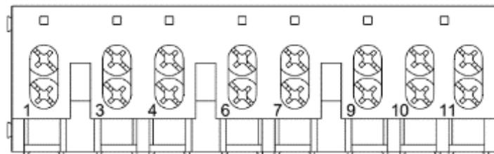
б) - обозначение контактов зажимов счетчика CE308 S31.745
