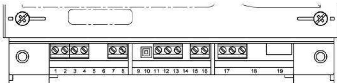
обозначение контактов счетчика CE308 S31, S34
