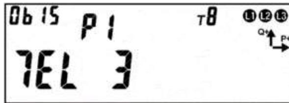
Рисунок 195 – Окно состояния и окно настроек для реле выполняющего функцию телеметрического выхода.
