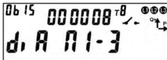
Рисунок 222 – Окно текущего состояния электронной пломбы.
