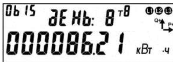
Рисунок 107 – Энергия зафиксированная на конец суток (за сутки).
