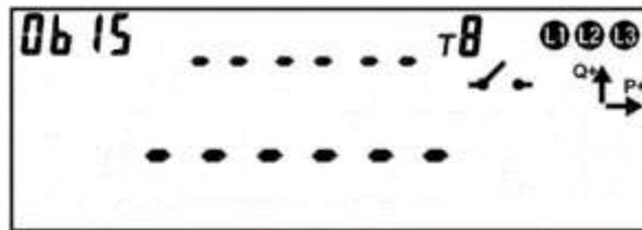
Рисунок 226 – Окно с незафиксированной электронной пломбой на вскрытие.
