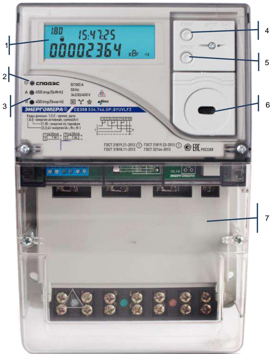
Рисунок 5 – Внешний вид счетчика CE308 S34
