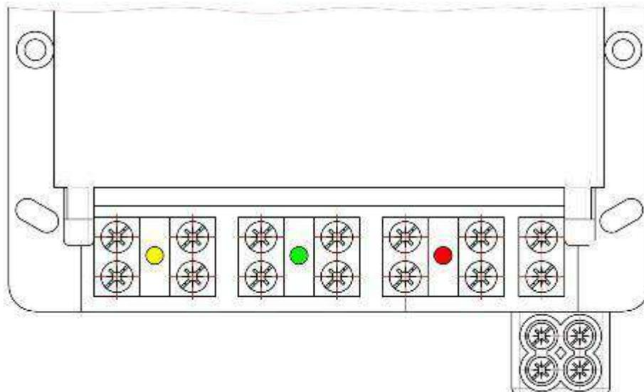
д) – обозначение контактов зажимов счетчика CE308 S34 с переходником для подключения второго нулевого контакта<sup>12</sup>
