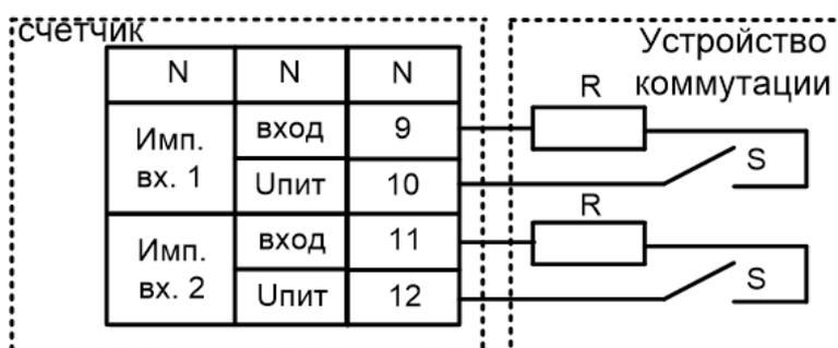
Рисунок 19 – Подключение импульсных входов
