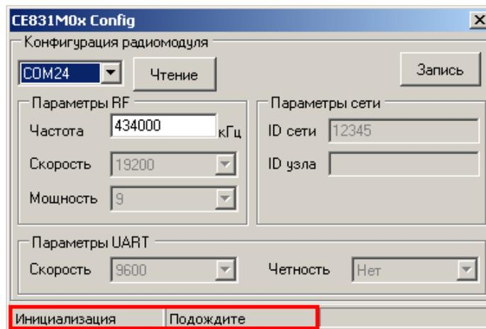
Рисунок 31 – Технологическое ПО CE831M0x Frequency Changer
