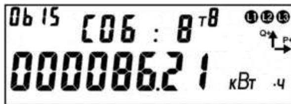
Рисунок 104 – Энергия зафиксированная по событию.
