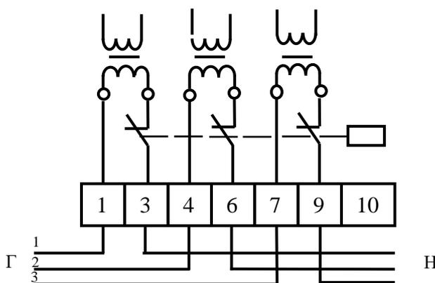
Рисунок 21 – Схема подключения счетчика с реле управления нагрузкой
