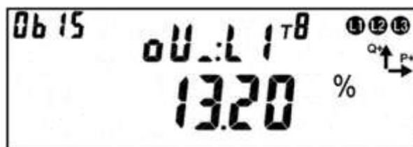
Рисунок 129 – Отклонение напряжения.
