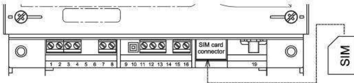
обозначение контактов счетчика CE308 S31, S34 для исполнений со встроенным GSM-модулем
