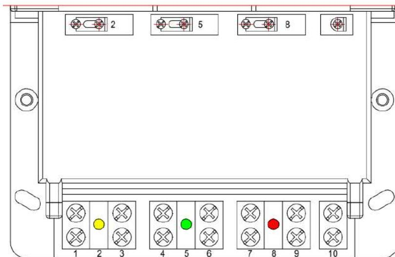
г) – обозначение контактов зажимов счетчика CE308 S34<sup>11</sup>
