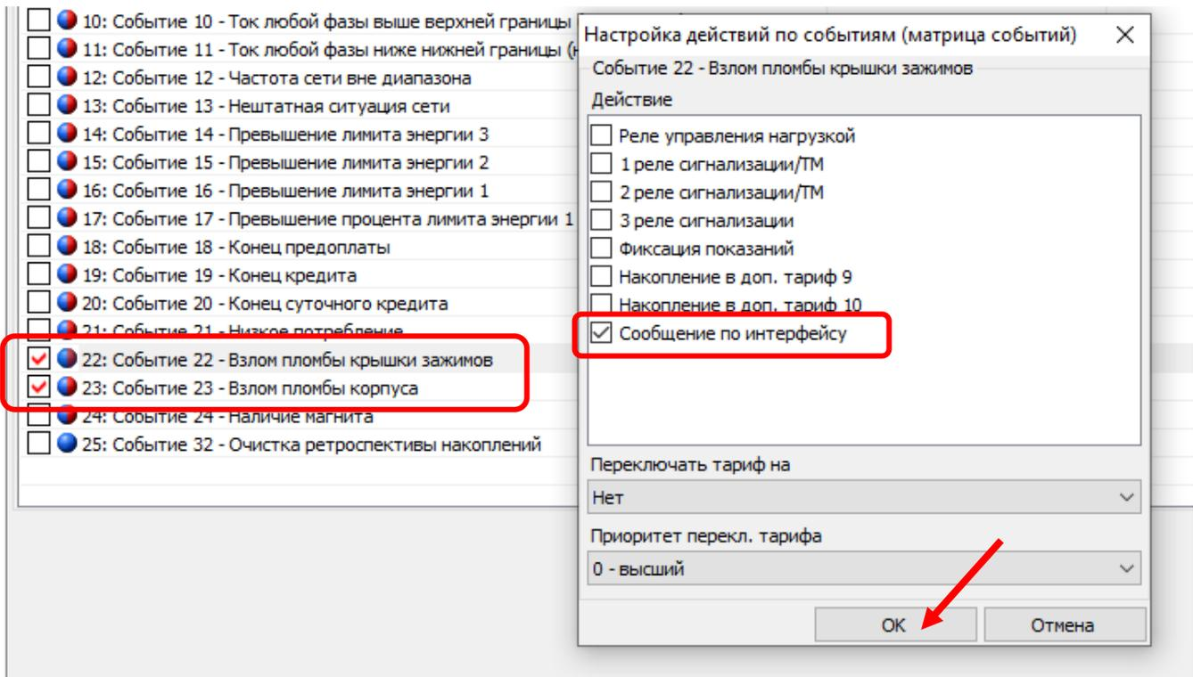
Рисунок 221 – Настройка событий на срабатывание электронной пломбы по интерфейсу.
