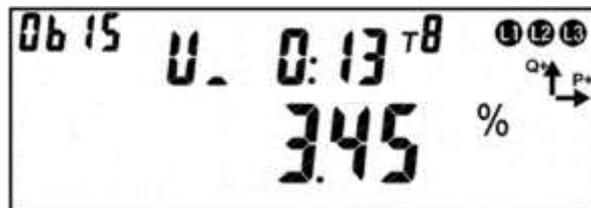
Рисунок 123 – Длительность провала напряжения и глубина провала.
