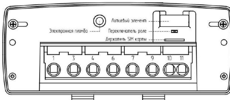
контакты 1...11 колодки – подключение сети и нагрузки.
