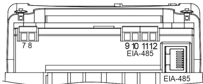
е) обозначение контактов счетчика с двумя интерфейсами EIA-485
