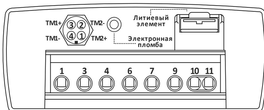
контакты 3, 4 разъема – подключение импульсных выходов TM1;
