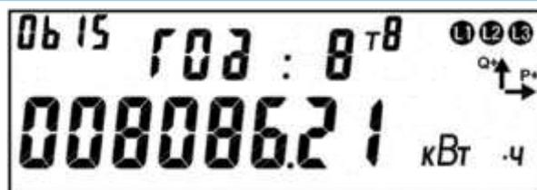
Рисунок 113 – Энергия зафиксированная на конец года (за год).
