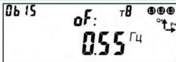
Рисунок 130 – Отклонение основной частоты напряжения электропитания от номинального значения.
