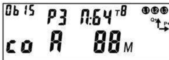
Рисунок 196 – Окно состояния реле сигнализации и РУН.
