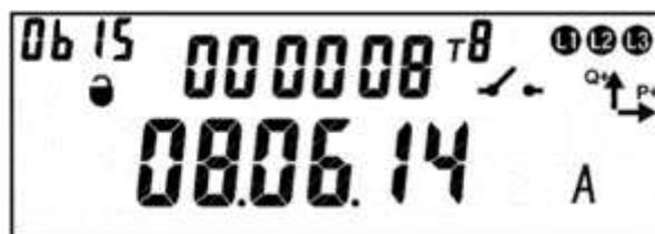
Рисунок 227 – Окно события «повторное вскрытие пломбы».
