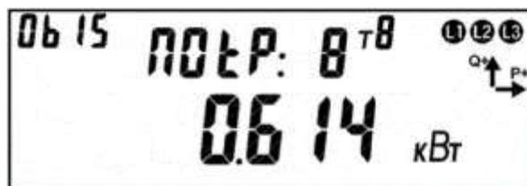
Рисунок 149 – Окно с зафиксированным максимумом мощности.
