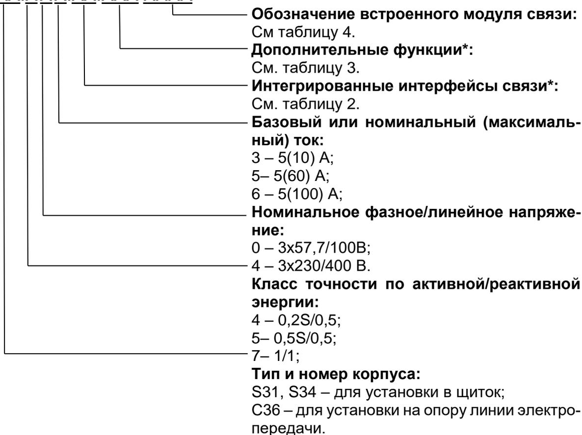
Рисунок 2 – Структура условного обозначения СЕ308
