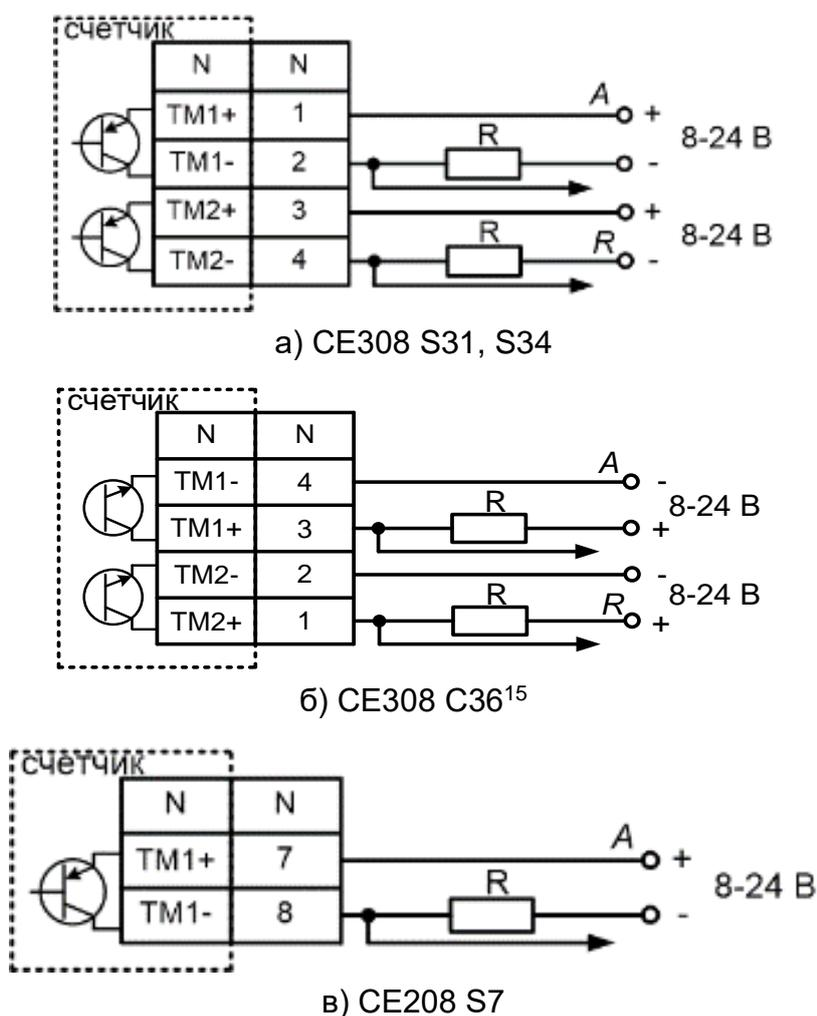
Рисунок 18 – Схема подключения импульсных выходов счетчика
