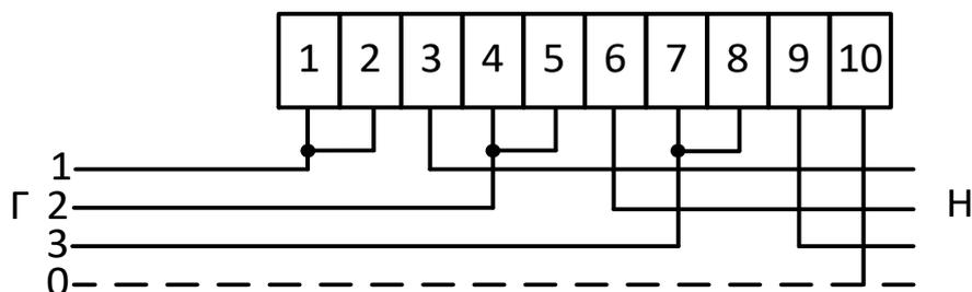
г) Схема подключения счетчика
