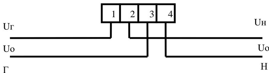
Рисунок 13 – Схема подключения CE208 XX
