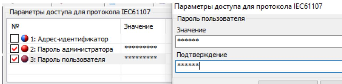
Рисунок 215 – Изменение параметров доступа по протоколу IEC 61107-2011.
