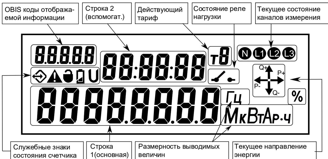
Рисунок 10 – Вид ЖКИ счетчика.
