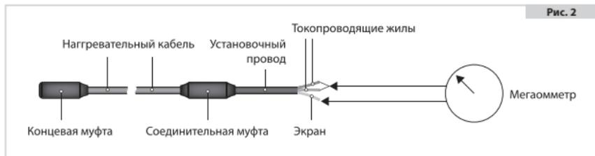
4.8. Измерение сопротивления нагревательной жилы проводят мультиметром (например, АСТАКОМ АМ 3003). Измерение сопротивления изоляции проводят мегаомметром (например, ЭСО 202/25) с испытательным напряжением постоянного тока 1000 В.
