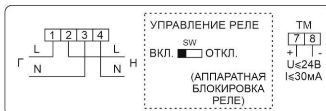
Рисунок Б.36 – Схема включения счетчиков в корпусах W9 с одним дискретным выходом и аппаратной блокировкой встроенного реле управления нагрузкой (с помощью микропереключателя)
