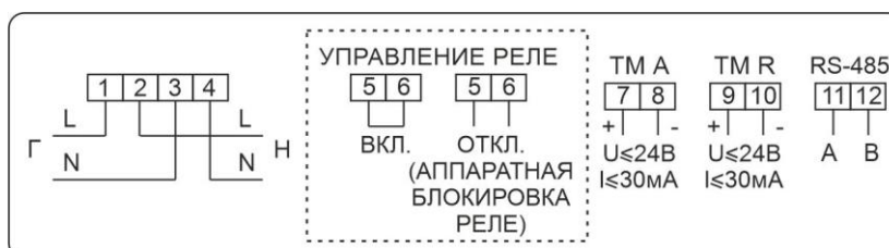
Рисунок Б.25 – Схема включения счетчиков в корпусах W3 с двумя дискретными выходами и интерфейсом RS-485 и аппаратной блокировкой встроенного реле управления нагрузкой (с помощью клеммника)
