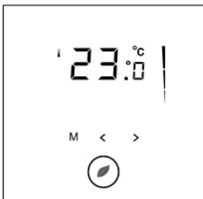
Нажмите кнопку "**<**" или "**>**" для отображения уставки температуры. В течение 5 секунд будет отображаться мигающее значение уставки температуры.
