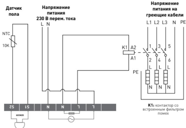
Подключение через контактор (пример для трех греющих элементов)
