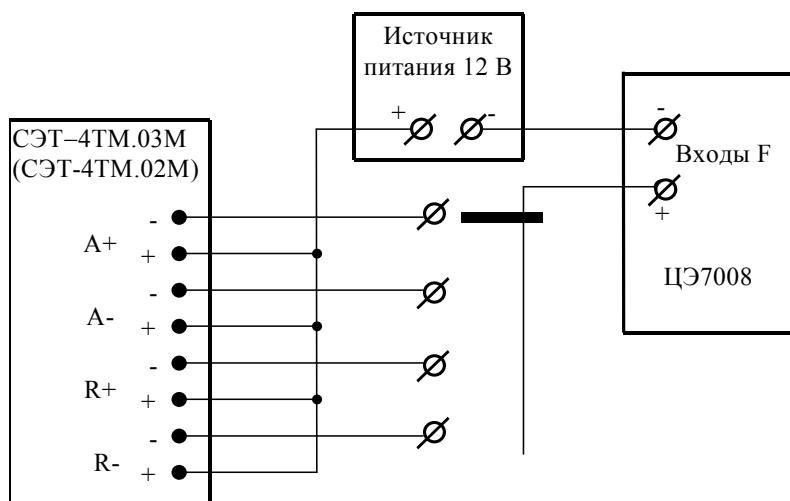
Рисунок А.3 - Схема подключения испытательных выходов счётчика
