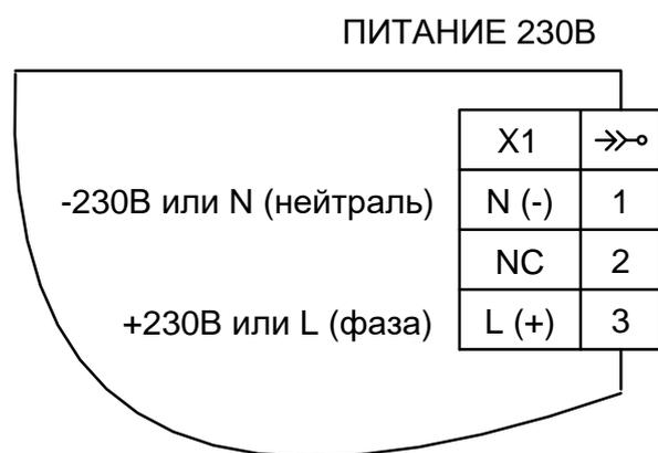
При подсоединении сети электропитания используется розетка типа 5EHDRСЗР. Контакт NC не используется.
