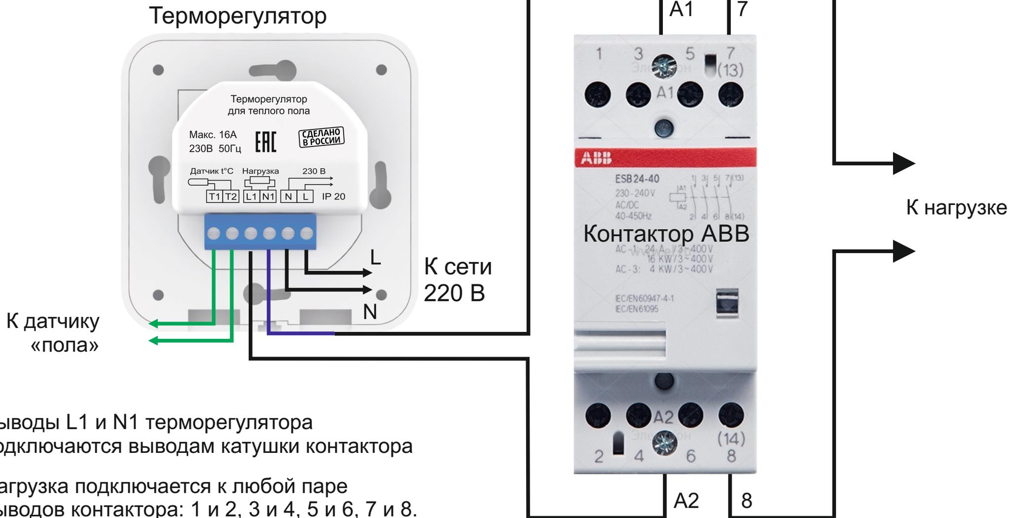
Выводы L1 и N1 терморегулятора подключаются выводам катушки контактора
