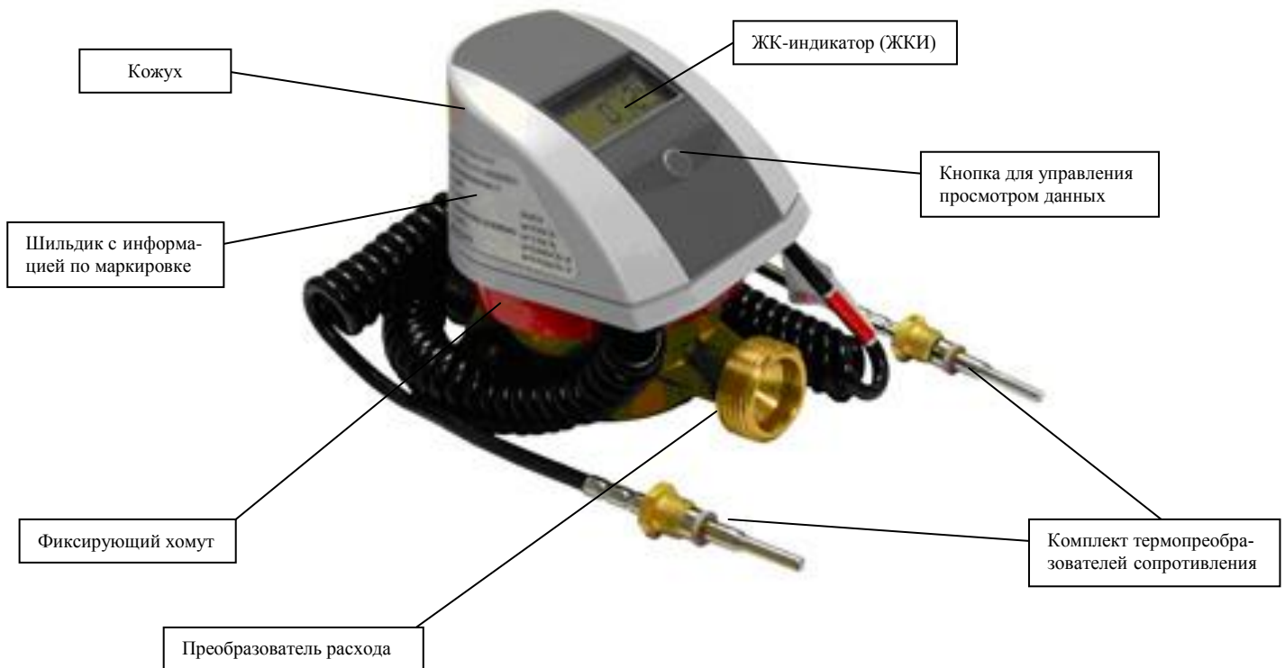
Рисунок 2. Внешний вид и состав теплосчётчика ELF-M
