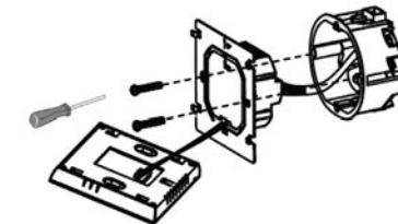
4. Соедините заднюю и переднюю панель: вставьте разъем в гнездо, затем совместите пазы в верхней части панелей, слегка нажмите на нижние углы передней панели, чтобы она защелкнулась.
