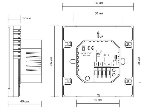
3. Установите заднюю панель в монтажную коробку (подрозетник) с помощью винтов и отвертки.
