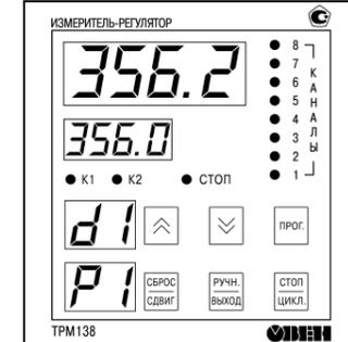
Рисунок 28 – Лицевая панель прибора ТРМ138–Щ4
