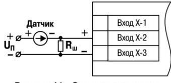
Рисунок 14 – Схема подключения пассивного датчика с токовым выходом 0...5 мА или 0(4)...20 мА Rш = 100,0 Ом ± 0,1%
