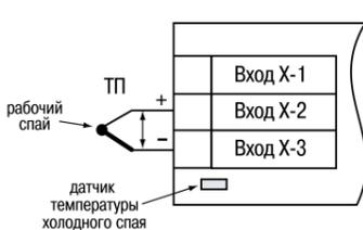
Рисунок 11 – Схема подключения терморпары
