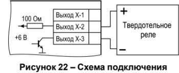
Рисунок 22 – Схема подключения нагрузки к ВУ типа Т
