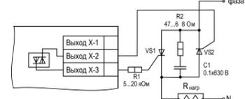
Рисунок 20 – Схема встречно-параллельного подключения двух тиристорных к ВУ типа С
