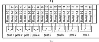
Рисунок 16 – Схема подключения электромагнитных реле прибора: 1) в корпусе Щ4, 2) в корпусе Щ7
