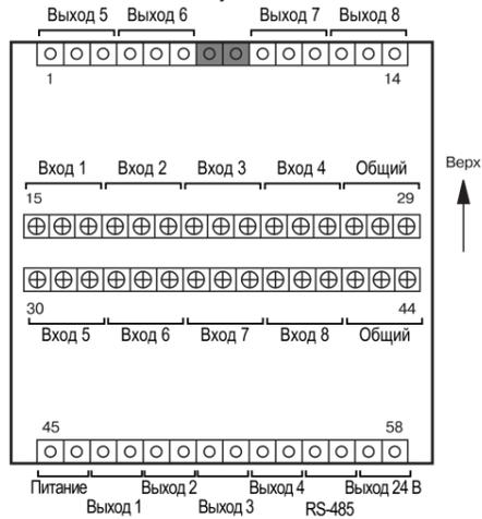
Рисунок 7 – Клеммник ТРМ138–Щ4
