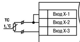
Рисунок 10 – Двухпроводная схема подключения ТС
