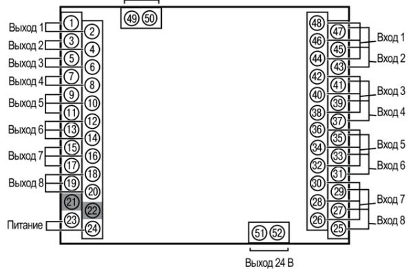
Рисунок 8 – Клеммник ТРМ138–Щ7
