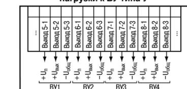
Рисунок 26 – Схема подключения выходных устройств прибора ТРМ13х-У
