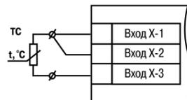
Рисунок 9 – Трехпроводная схема подключения ТС
