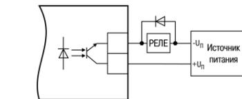
Рисунок 17 – Схема подключения нагрузки к ВУ типа К
