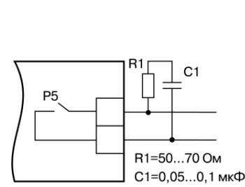
Рисунок 15 – Схема подключения нагрузки к ВУ типа Р
