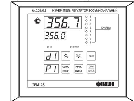
Рисунок 29 – Лицевая панель прибора ТРМ138–Щ7
