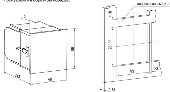
Рисунок 2 – Габаритные размеры корпуса Щ4
