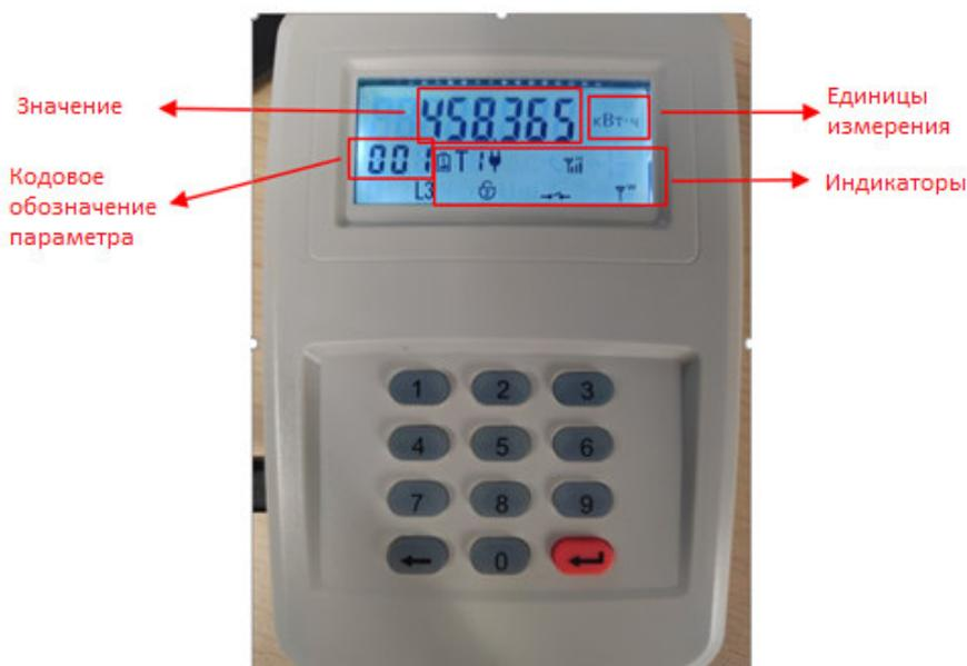
Режим ручной прокрутки может быть активирован нажатием на кнопку ввода “↵”. Переключение осуществляется путем короткого нажатия на ту же кнопку ввода “↵”. По истечении 60 секунд после освобождения или нажатия кнопки возврата «←» устройство возвращается в режим автоматической прокрутки.
