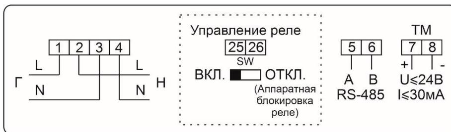
**Рисунок Б.1 – Схема включения счетчика в корпусе D17 с одним дискретным выходом, интерфейсом RS-485 и аппаратной блокировкой встроенного реле управления нагрузкой**
