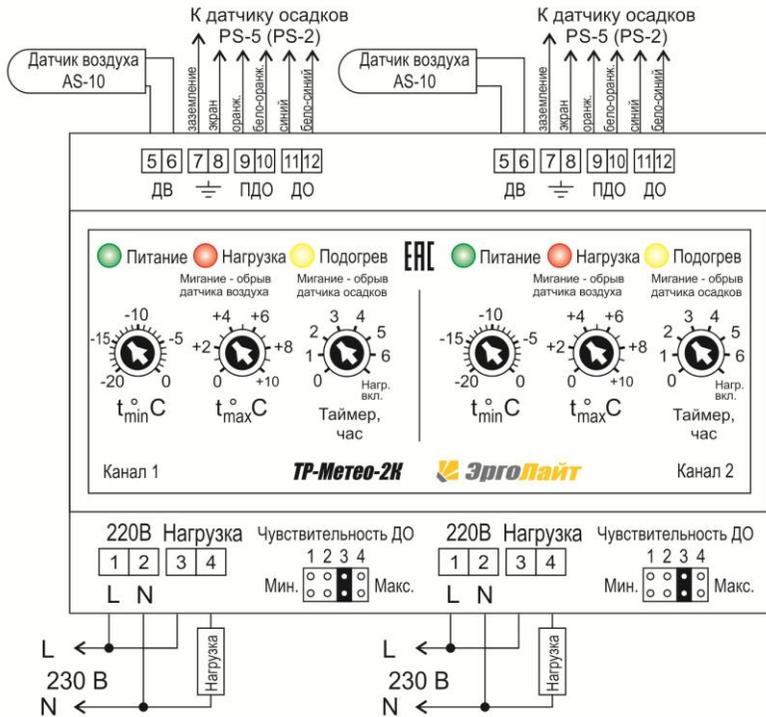
**Монтаж датчика осадков/почвы**
