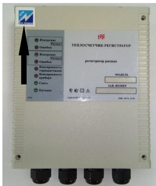
Рисунок 7 – Схема пломбировки от несанкционированного доступа, обозначение места нанесения знака поверки на корпус регистратора расхода раздельно-выносного исполнения
