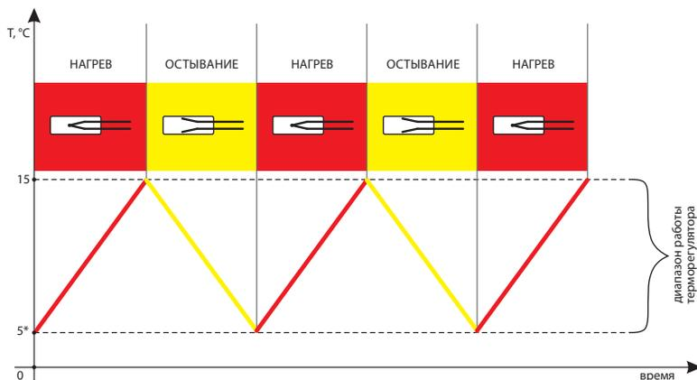
\* Секция нагревательная кабельная включается в сеть при положительной температуре окружающей среды, чтобы исключить возможность замерзания продукта в трубопроводе. Для предварительного прогрева пустого трубопровода необходимо включить нагревательную секцию в сеть на 5 минут перед пуском продукта (пустой трубопровод допускается прогревать при температуре не ниже  $-20\text{ }^\circ\text{C}$ ).
