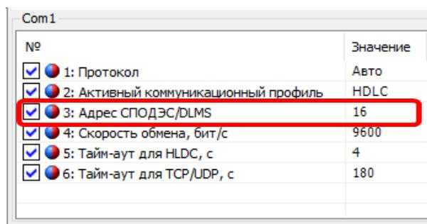
Рисунок 28 – Адрес СПОДЕС/DLMS.
