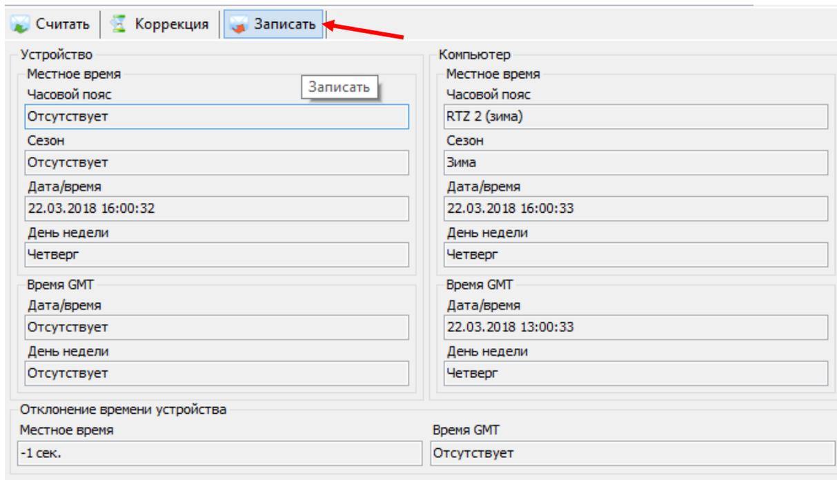
Рисунок 82 – Запись времени в счетчик
