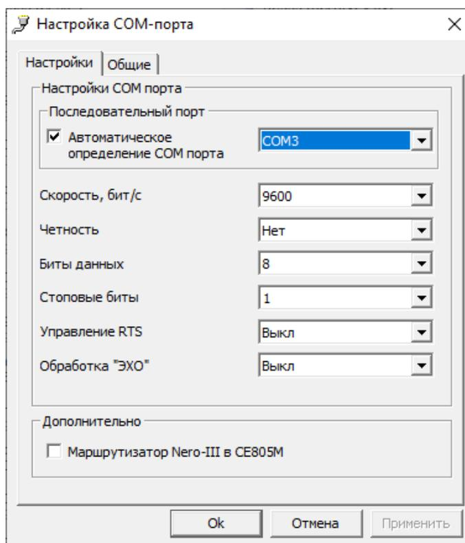
Рисунок 20 - Окно редактирования настроек канала связи «EIA-232»
