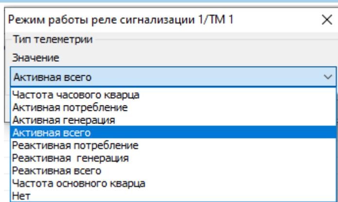
Рисунок 53 – Типы телеметрии
