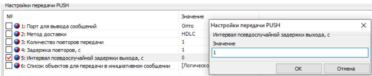
Максимальное значение интервала псевдослучайной задержки выхода – 255 секунд.
