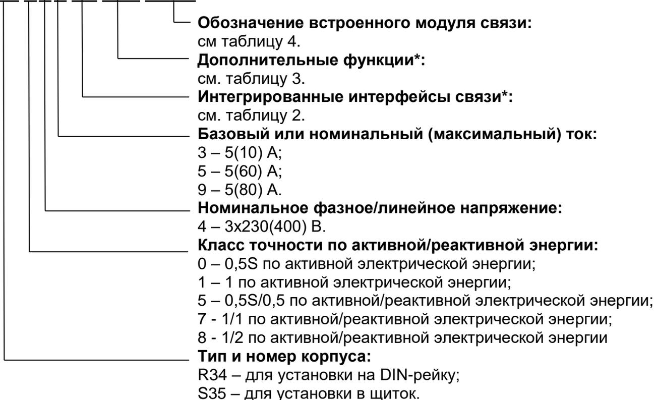
Рисунок 1 – Структура условного обозначения СЕ 307
