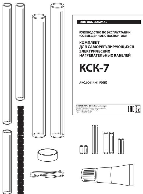
Комплект КСК-7 предназначен для соединения высокотемпературных саморегулирующихся электрических нагревательных кабелей марок МТК (свыше 125 °С) и ВСК с оболочкой из фторопласта с максимальной температурой воздействия 190 °С. Комплект КСК-7 включает в себя термоусаживаемые трубки на основе фторполимера, припой, медную луженую плетенку, фторопластовую ленту и клей-герметик.
