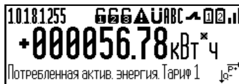
Рисунок 3 – Пиктограммы состояния счетчика и электронных пломб
