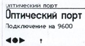
Оптический интерфейс электронного индекса предназначен для настройки счетчика перед началом эксплуатации и считывания данных о потреблении газа. Настройки счетчика выполняются с помощью сервисного программного обеспечения ПО Themis Opto.
