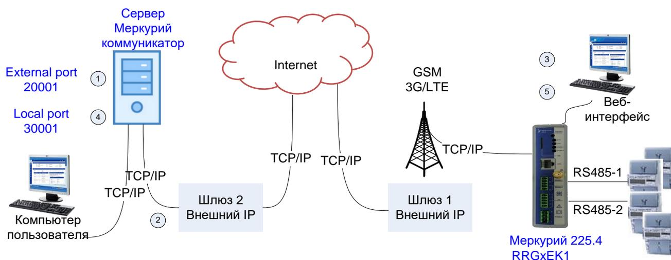
**Рисунок 21.1 – Схема работы в режиме прямого канала**
