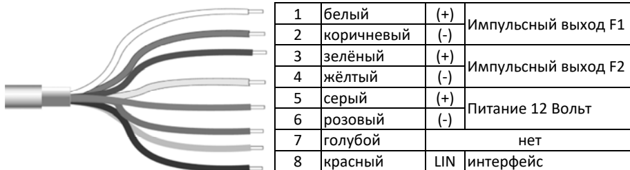
Рис. 3 Схема подключения расходомера с IP68
