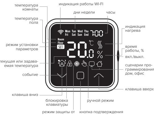
Дисплей Вашего терморегулятора имеет функцию SCI, обеспечивающую превосходную четкость и контрастность символов, увеличенный угол обзора, а также комфортное восприятие информации.
