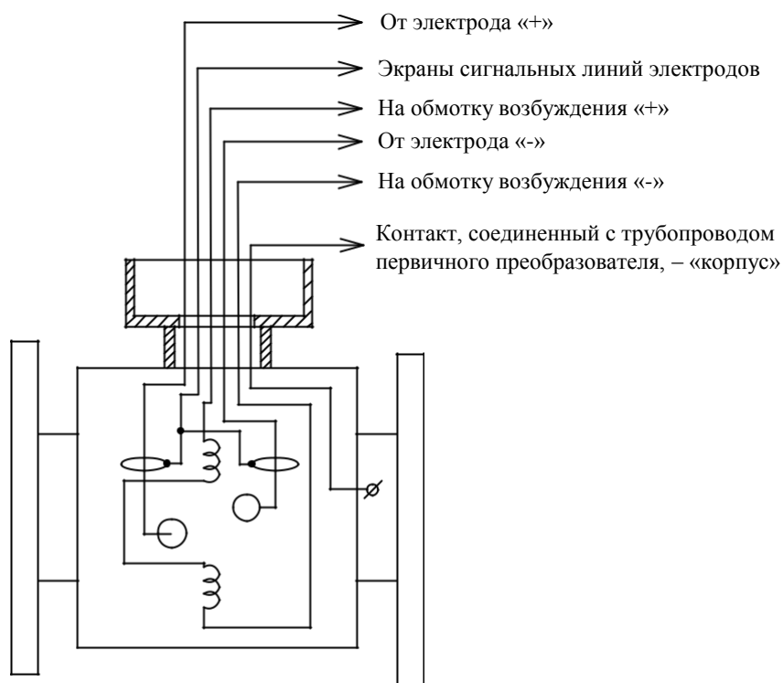
Рисунок Ж1 - Общая схема первичного преобразователя расхода
