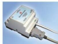
Адаптер GT232-485 является преобразователем собственного протокола RS232 в протокол RS485. Шлюз предназначен для увеличения длины линии связи между теплосчётом и диспетчерским пунктом, а также объединения нескольких теплосчетчиков «Магика» в локальную единую сеть. Сеть организуется путём их параллельного подключения к линии связи RS485. Общая протяжённость сети может достигать 1000 м. Количество абонентов - до 32 шт. Для соединения шлюзов используется кабель типа «витая пара» в оплётке.
