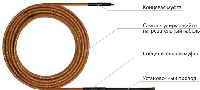
Рис. 1. Конструкция нагревательной секции
