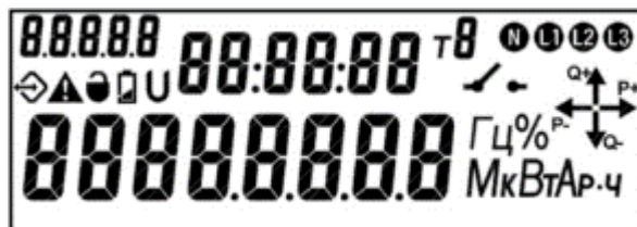
Рисунок 151 – Тестирование сегментов ЖКИ.
