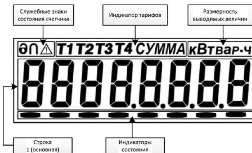
Рисунок 4 – Вид ЖКИ счетчика.
