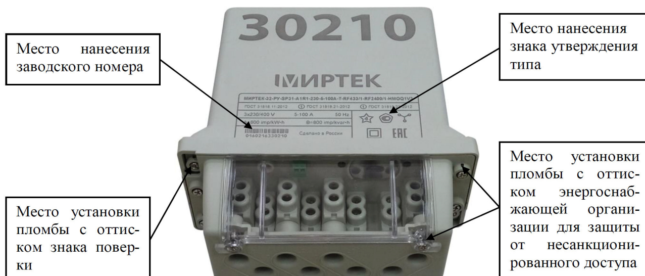
Рисунок 9 – Общий вид счетчика в корпусе типа SP31
