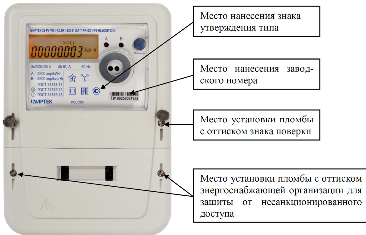
Рисунок 1 – Общий вид счетчика в корпусе типа W31
