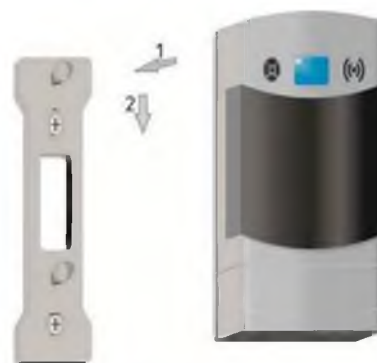
Рисунок 5 – Установка сигнализатора на монтажную панель
