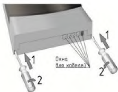
Рисунок 4 – Снятие крышки клеммного отсека
