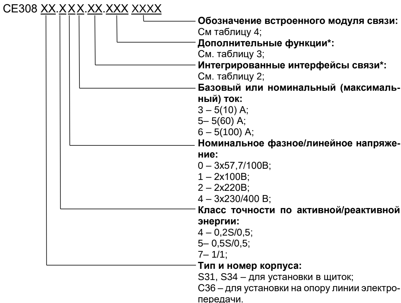
Рисунок 3 – Структура условного обозначения СЕ308
