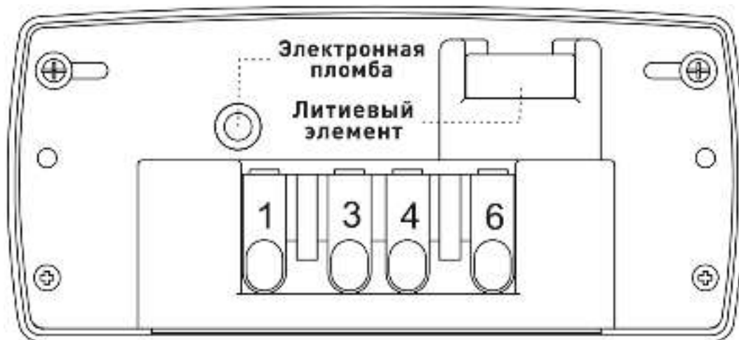
а) – первый вариант обозначения контактов зажимов счетчика CE208 C4
