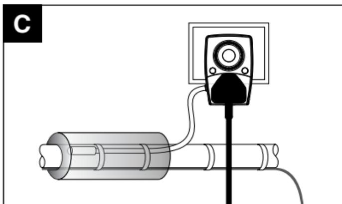
Новое устройство управления FrostGuard-ECO (230 В) оптимизирует расход электроэнергии и температурный режим при работе с греющими кабелями для защиты водопровода от замерзания Raychem FrostGuard.
